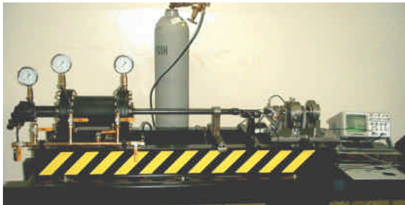
Rys. 8. Stanowisko badawcze w Laboratorium IPPT dla zakresu predkosci odkształcenia 5000 \div 100\,000 1/s.
