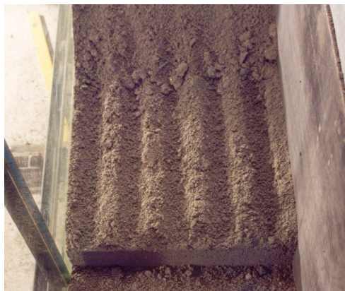
Rys. 2.37. Widok próbki po wykonaniu testu skrawania łyżką z 5-ciooma zębami.
