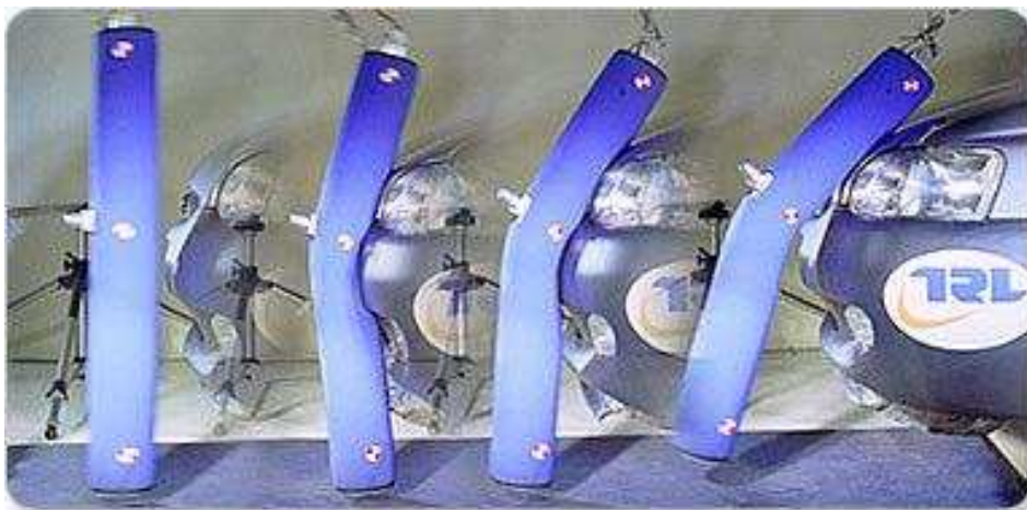
Rys. 6.21. Próba zderzeniowa na fantomie kończyny dolnej. Zdjęcie z pracy [99], dzięki uprzejmości Iztoka Cigralica z TUG.
