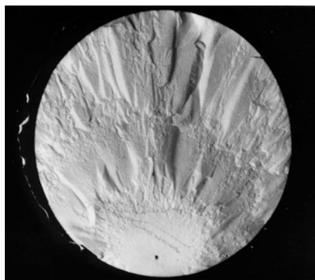
Rys. 3.3. Przełam pnia izolatora z wtrąceniem i przylegającym do niego płaskim obszarem kruchych pęknięć – tzw. „lustrem”.
