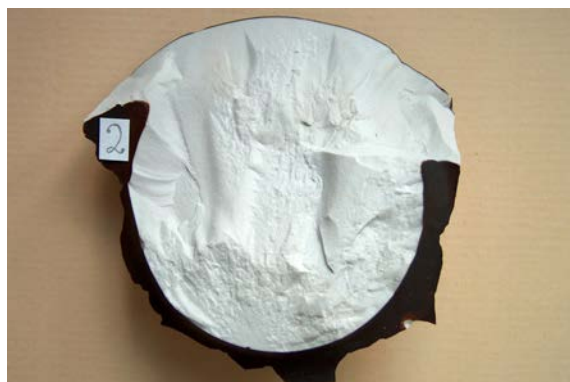
Rys. 8.3. Przełam pnia izolatora LS 75/21 z 1970 roku, oznaczonego 2. W dolnej części widoczne jest drobne wtrącenie na granicy porcelany i szkliwa oraz towarzyszący mu niewielki obszar kruchych pęknięć – tzw. „lustro”.
