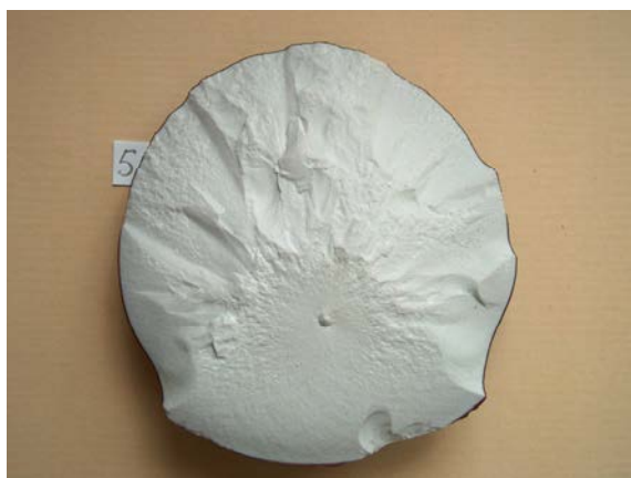
Rys. 8.4. Przełam pnia izolatora LS 75/21 z 1970 roku, oznaczonego jako 5. Uwagę zwraca duże wtrącenie oraz rozległy obszar „lustra”.
