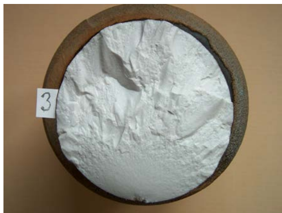
Rys. 8.14. Obraz przekładu izolatora LS 75/21 z 1971 roku, oznaczonego 3. Widoczne jest duże wtrącenie na granicy pnia i towarzyszący mu rozległy obszar kruchych pęknięć – tzw. „lustro”.
