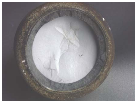
Rys. 8.5. Przelam zerwanego po wieloletniej eksploatacji izolatora odciągowego VKLF 75/16 z 1967 roku. Widoczny jest niezbyt rozległy obszar o zaburzonej teksturze.
