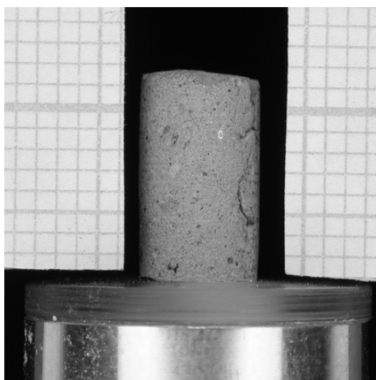
Fig. 4. Mikrordzeń na obrotowym stoliku napędzanym silnikiem krokowym (wstępna wersja).
