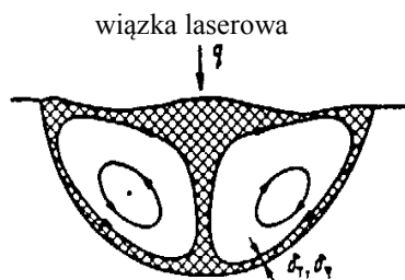
Rys.1.21. Schemat przepływu cieczy przy dużych liczbach Reynoldsa [52].
