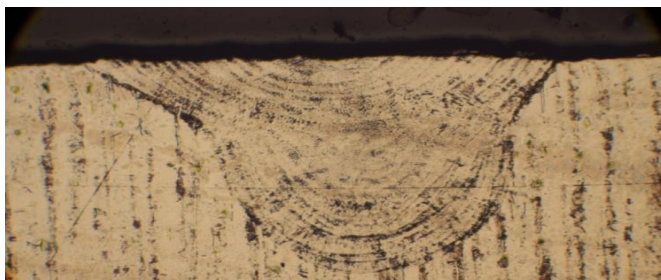
Rys.3.32. Kształt strefy przetopienia stali 304, prędkość posuwu 150 mm/min.
