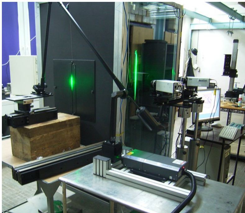
Rys. 3.7: Układ doświadczalny z systemem Stereo-PIV. Na pierwszym planie widoczny laser impulsowy. Wiązka laserowa jest kierowana do szczeliny w komorze wykorzystując tzw. ramię świetlne. Płaszczyzna świetlna tworzona przez zastosowanie układu optycznego z soczewką cylindryczną oświetla wnętrze komory, w której zachodzi badany proces mieszania. Przed komorą widoczne są kamery w ustawieniu stereoskopowym oraz komputer sterujący systemem i archiwizujący dane.
