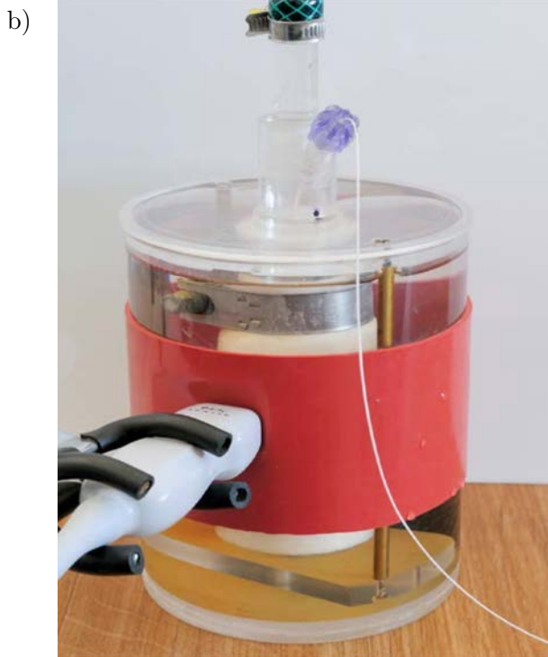
Rys. 5.5. a) Schemat blokowy eksperymentu, b) zdjęcie wzorca lewej komory serca.
