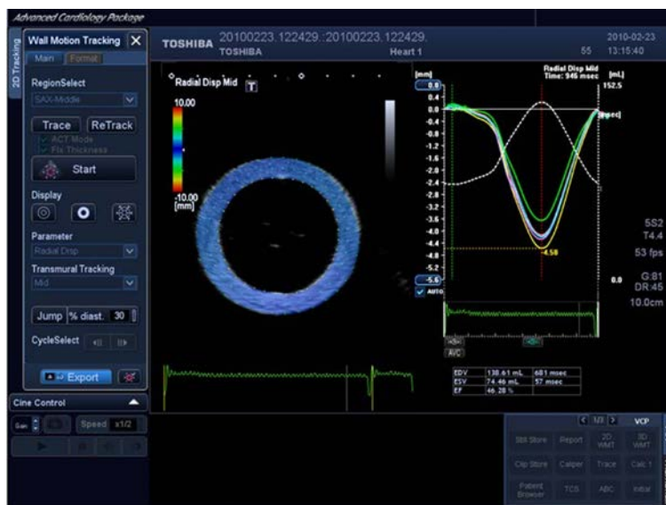
Rys. 6.16. Obraz echokardiograficzny wzorca lewej komory serca wykonanego z gąbki poliuretanowej o otwartych porach WGP. Część lewa – obrazowanie dwuwymiarowe ruchu w kierunku radialnym ( radial displacement ) ściany wzorca w projekcji poprzecznej. Część prawa – krzywe przemieszczenia radialnego w cyklu pracy serca; kolory linii odpowiadają poszczególnym segmentom.
