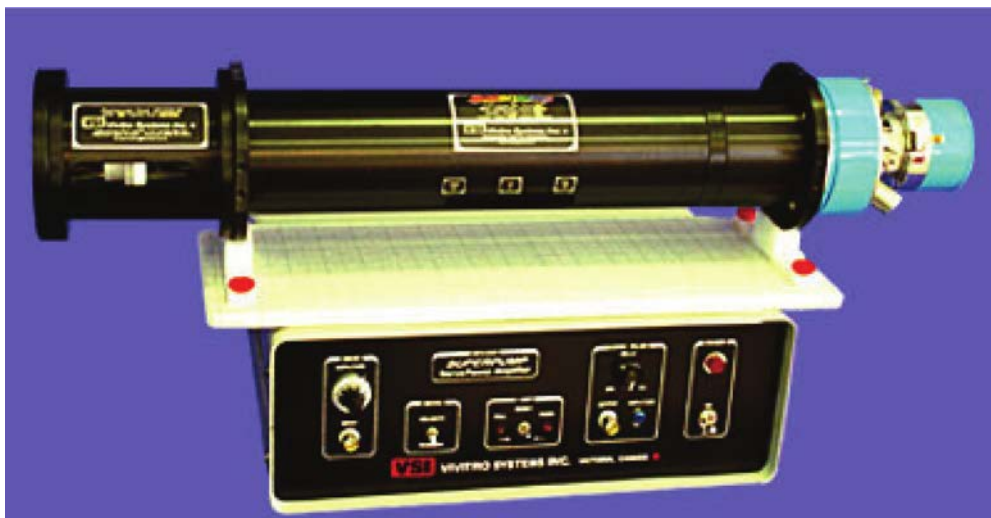
Rys. 5.2. Pompa tłokowa Vivitro Inc. TM do poruszania wzorca lewej komory serca.
