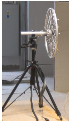
Rysunek 7.13. Widok matrycy mikrofonowej.
