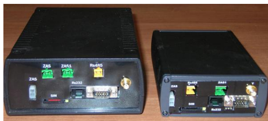
Rysunek 6.14. Moduły rozszerzone I/O.
