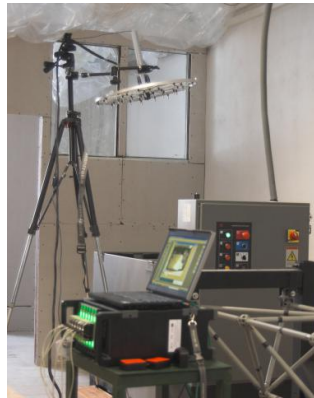
Rysunek 7.18. Widok stanowiska badawczego wraz z matrycą mikrofonową.
