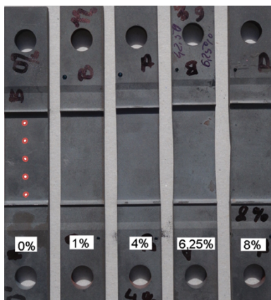
Rysunek 5.29. Zestaw próbek ze stali 1.4903 po pełzaniu, o różnym stopniu deformacji. Miejsca pomiaru kąta fazowego \varphi są oznaczone na próbce 0%.
