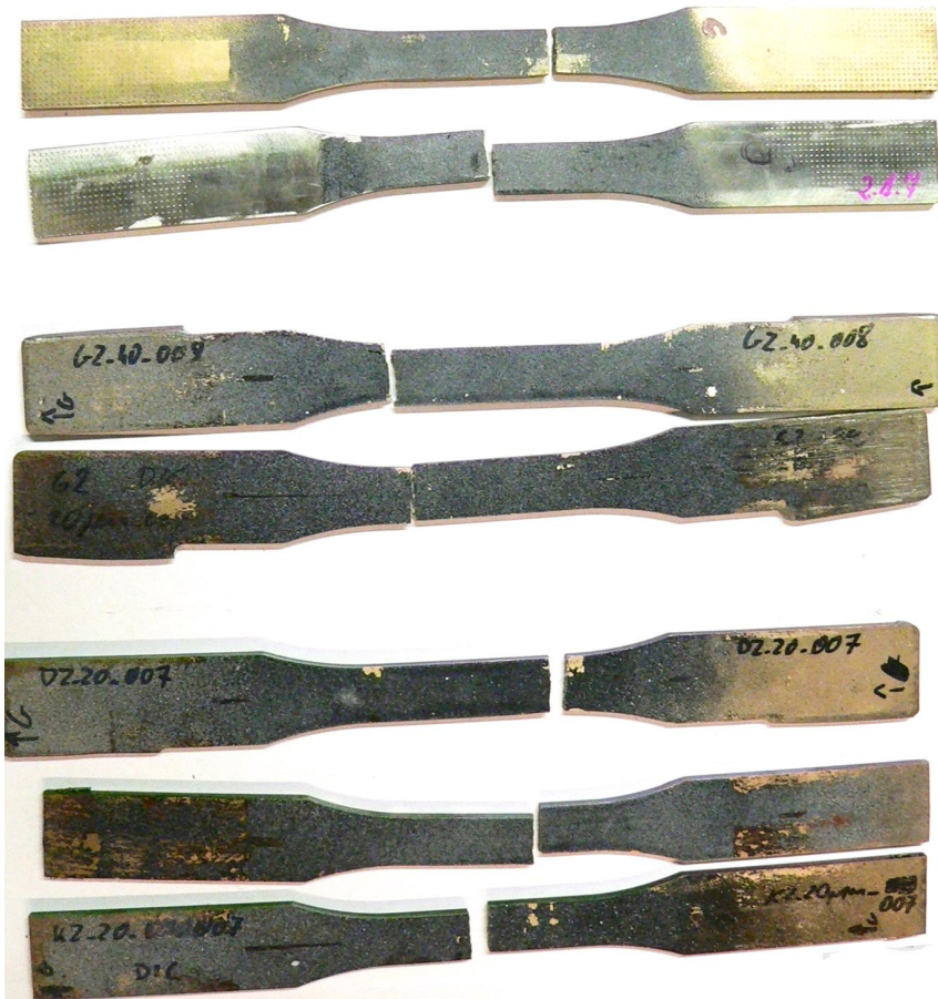
Rysunek 6.14. Pęknięte próbki z warstwą kontrastową poddane badaniu DIC.
