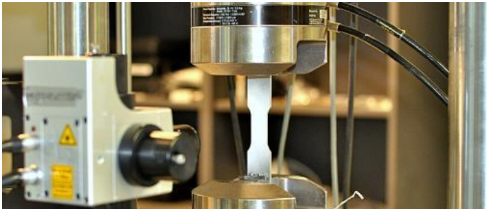
Rysunek 6.20. Stanowisko badawcze do oceny rozkładu deformacji metodą ESPI.
