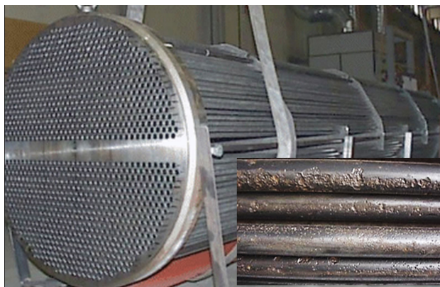
Rysunek 2.6. Rurowy wymiennik ciepła z przykładowymi defektami w postaci ubytków erozyjnych i korozyjnych.
